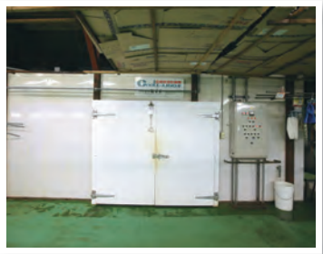
制御方法の改善で省エネに成功したにしん乾燥用の「冷風除湿乾燥機」
