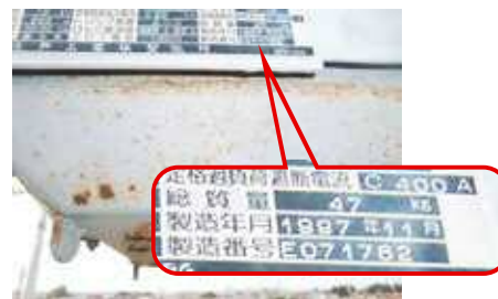
塗装が剥がれ、めくれた箇所に錆が発生した様子
