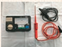
低圧絶縁抵抗計 (125V/250V/500V切替)
