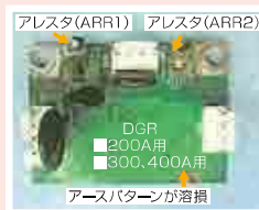
過電流信号処理基板損傷
