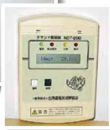
デマンド監視表示器
