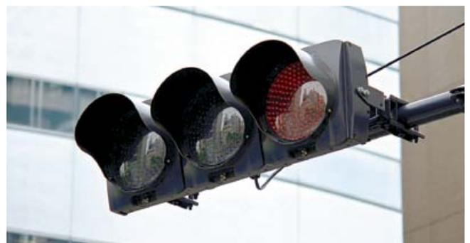
図4 LED化が進む信号機
