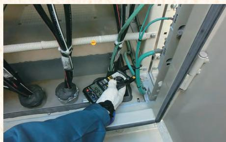
B種接地線による漏れ電流測定状況
